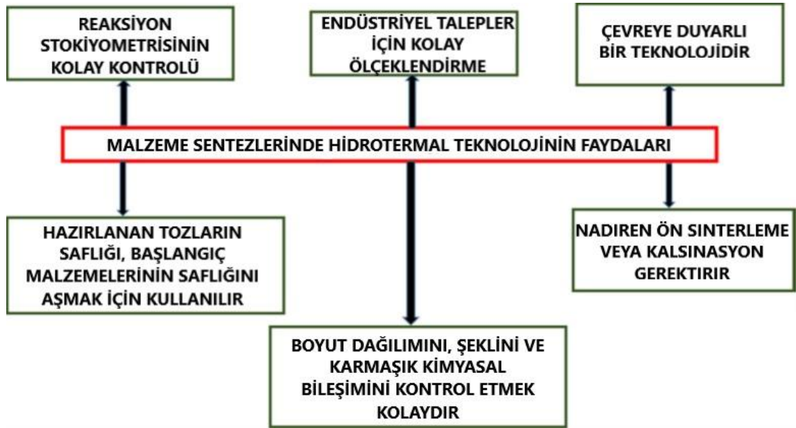
Şekil 2.10. Malzeme sentezinde hidrotermal tekniklerin avantajları (Yamakov vd., 2004; Gan, 2020; Heo, 2015; Tuncolu vd., 2015).
