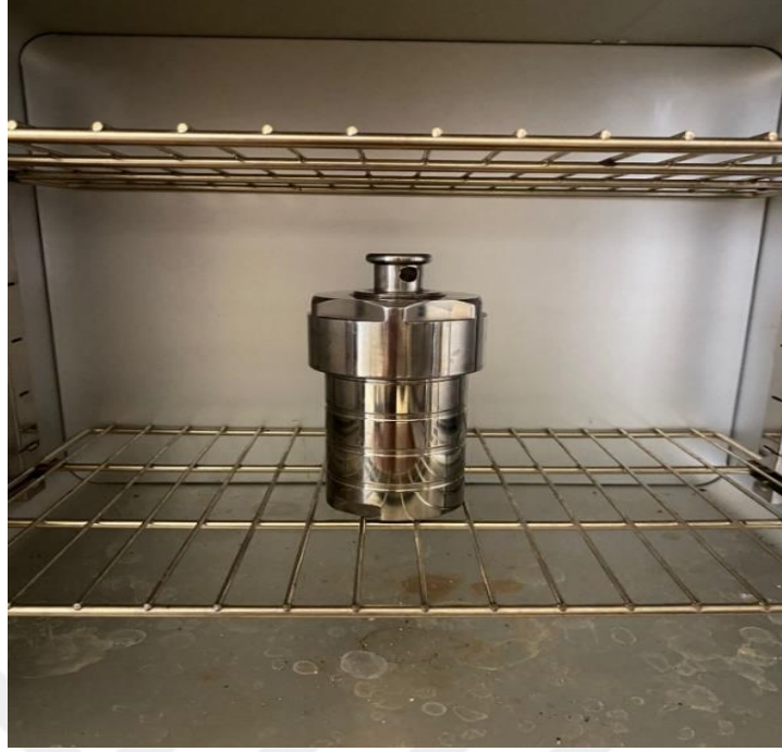
Şekil 3.2. Hidrotermal reaktörün etüve yerleştirilmesi
