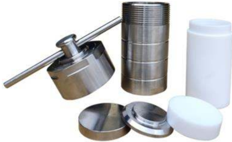
Şekil 3.1 Hidrotermal teflon reaktör
