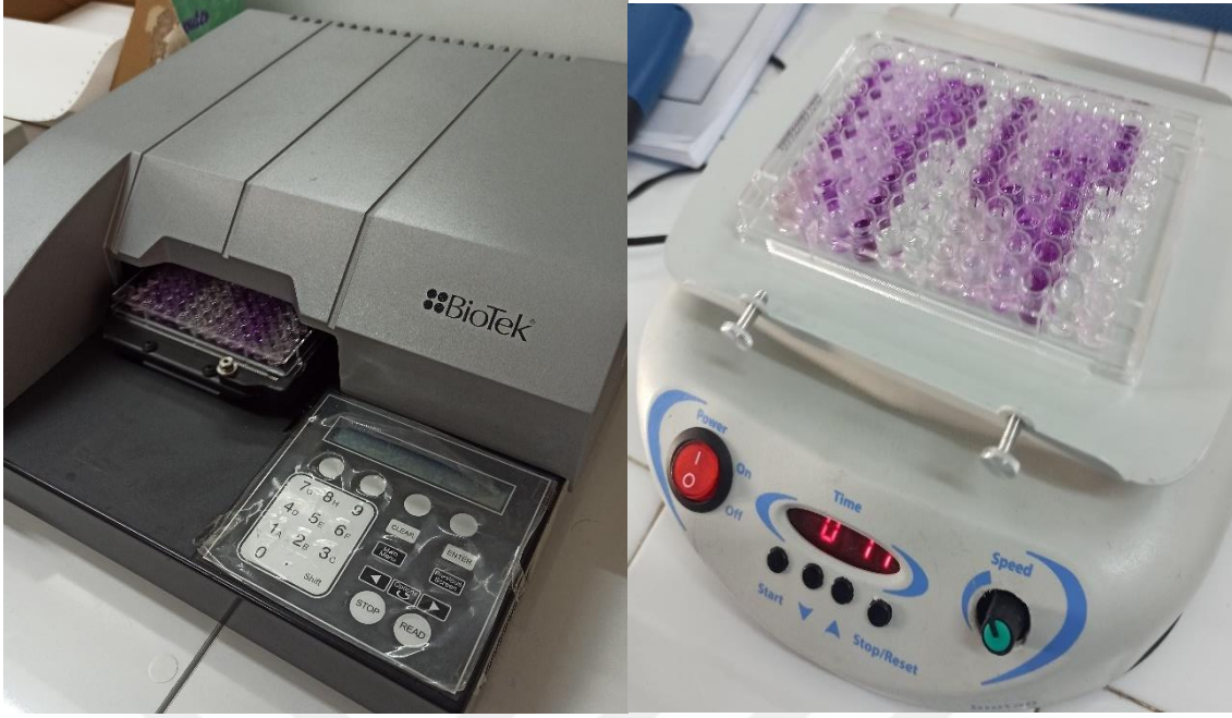
Resim 3.7 Numune absorbanlarının belirlendiği multiplate okuyucu ve numunelerin çalkalanmasında kullanılan yatay çalkalayıcı.
