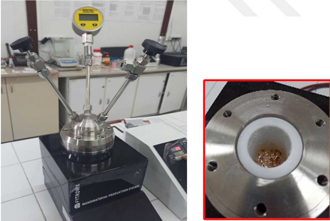
Resim 3.4 Blend yapımı için kullanılan araç (Fytronix nanomalzeme üretim cihazı).
