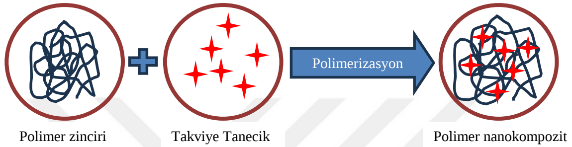
Şekil 2.9 Tanecik takviyeli polimer nanokompozitlerin tipik yapısı.
