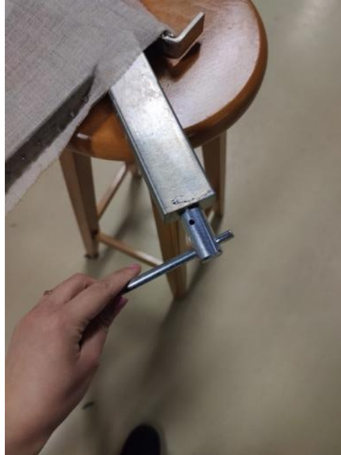
Şekil 5.5: Bezin gerilmesini sağlayan köşe aparatları.
