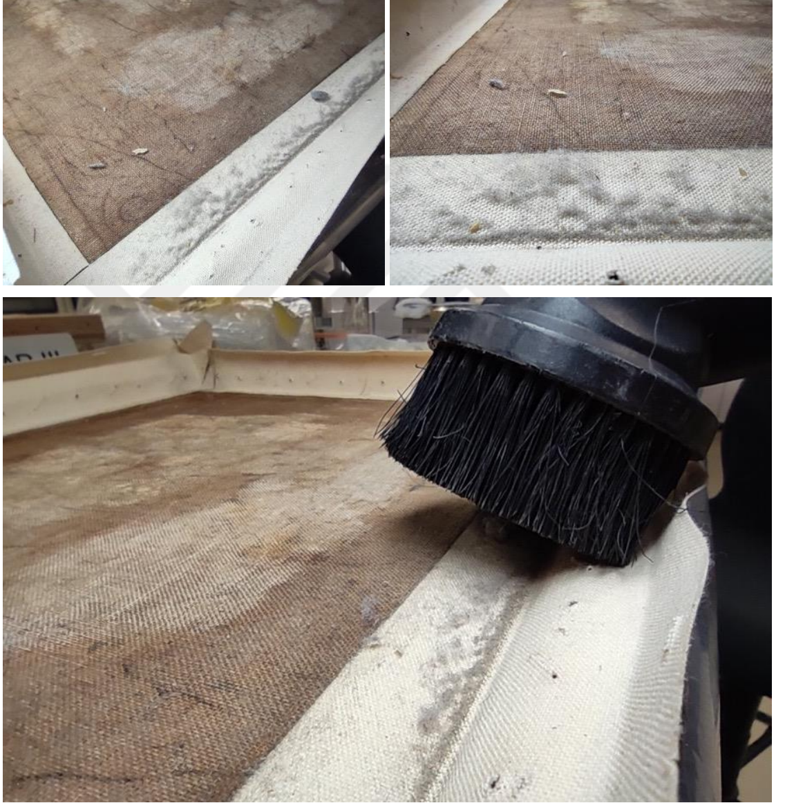
Şekil 4.17: Şasinin altındaki toz birikintilerinin temizlenmesi.
