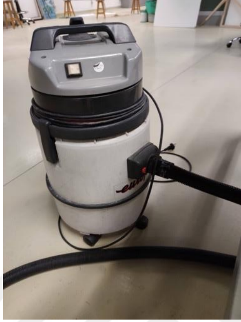
Şekil 5.16: Vakumlamayı sağlayan elektrik süpürgesi.
