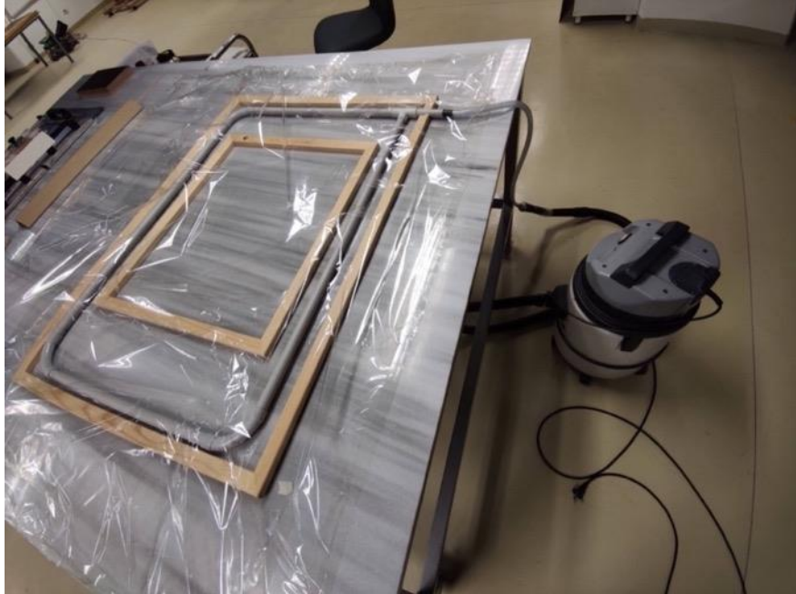
Şekil 5.17: Mist-lining vakumlama sistemi, kurulum sonrası.
