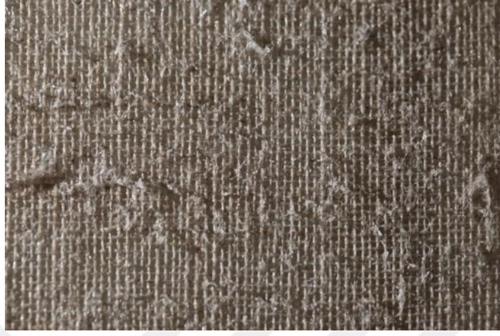
Şekil 5.20: Püskürtülen yapıştırıcının yakın çekim görüntüsü.
