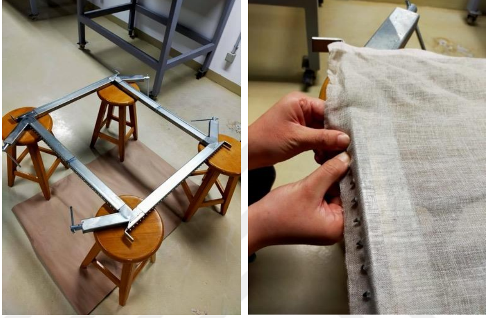
Şekil 5.4: Metal germe çubuklarının hazırlanması ve bezin sabitlenmesi.
