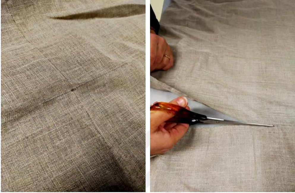
Şekil 5.2: İp çekme sonrası oluşan referans görüntüsü ve bezin kesilmesi.
