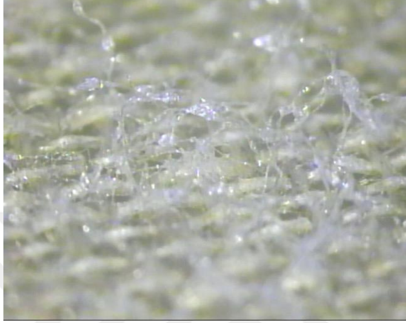
Şekil 5.21: Püskürtülen yapıştırıcının mikroskop görüntüsü, 5X.
