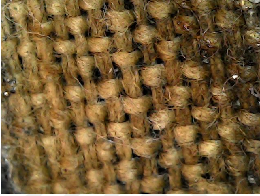
Şekil 3.11: Orijinal tuval bezinin mikroskop görüntüsü, 2,5X.
