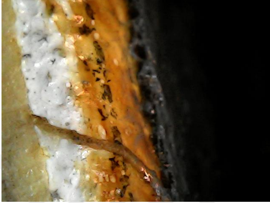
Şekil 3.27: Kenar astarlama mikroskop görüntüsü, 2,5X.
