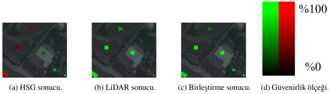
Şekil 5.10: İncelenen ikinci bölgenin yakınlaştırılmış görüntüleri. HSG sınıflandırma sonucu (a) ile LiDAR sınıflandırma sonucunun (b) birleştirilmesi sonucunda c’de gösterilen sınıflandırma elde edilmiştir. (Yeşil: doğru, Kırmızı: yanlış)
