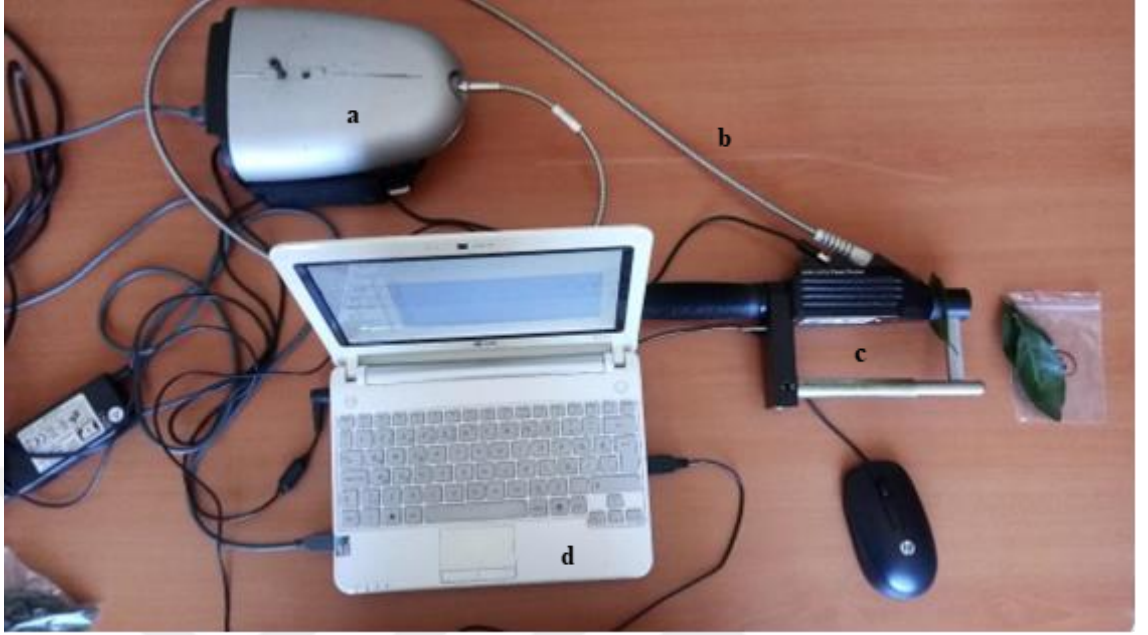
Şekil 3.2. Laboratuvar ortamında kullanılan donanımlar: a) Spektroradyometre; b) Fiber kablo; c) Bitki probu ve yaprak klipsi; d) Bilgisayar
