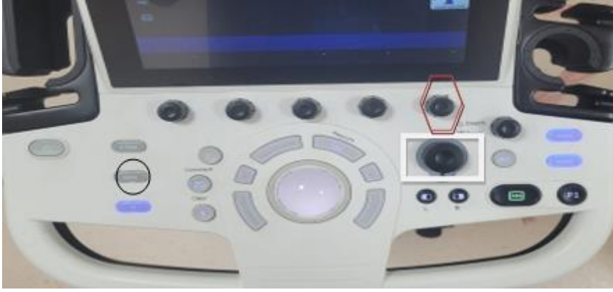
Şekil 3. 11. USG Cihazında B Mod (Beyaz Dikdörtgen), Renkli Doppler (Color Flow, CF) (Kırmızı Altıgen) ve Elastografi (Siyah Daire) İçin Seçim Paneli.
