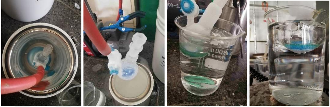
Şekil 3.3. Freeze–pump–thaw yöntemiyle çözünmüş gazların uzaklaştırılması
