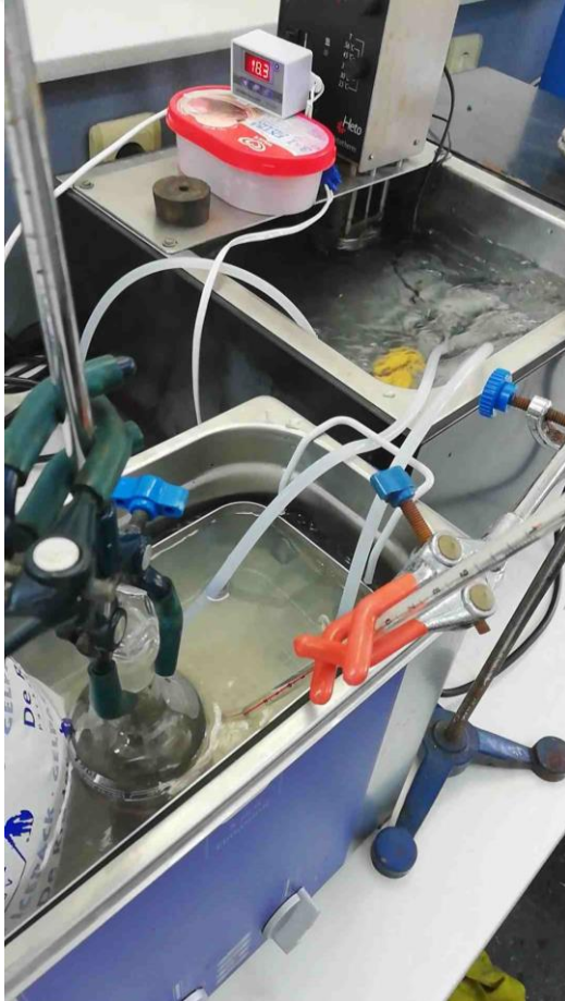
Şekil 7.5. Manyetik nanoparçacıkların (MNP) yüzeyinin ultrasonik banyoda PEG- b -PDMAEMA ile modifikasyonu
