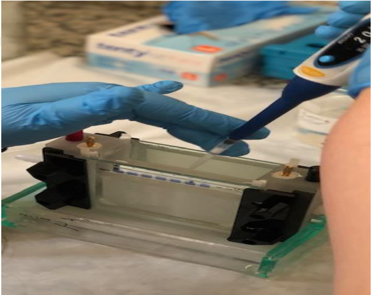
Resim 2: Elektroforez düzeneğine numunelerin yüklenmesi
