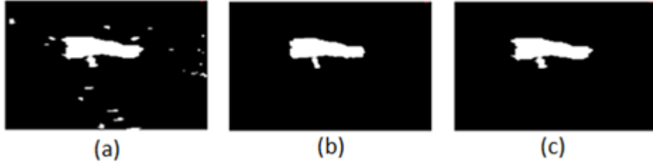
Şekil 3. 3 (a) Kümeleme sonucu oluşan görüntü (b) Gürültülü görüntüye uygulanan aşınmadan sonra elde edilen çıktı (c) Nesnenin bütünlüğünü korumak için görüntüye genişleme işleminin gerçekleştirilmesi sonucu elde edilen çıktı
