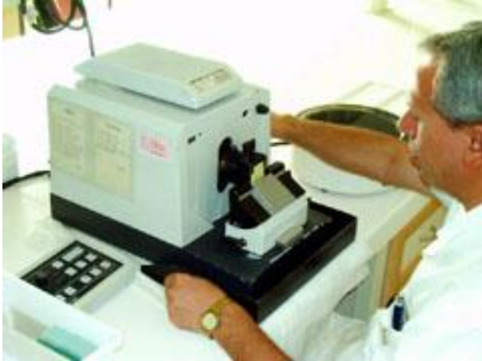
Şekil 3.4 Parafin blokların mikrotom cihazı ile kesimi (Anonim,2014)
