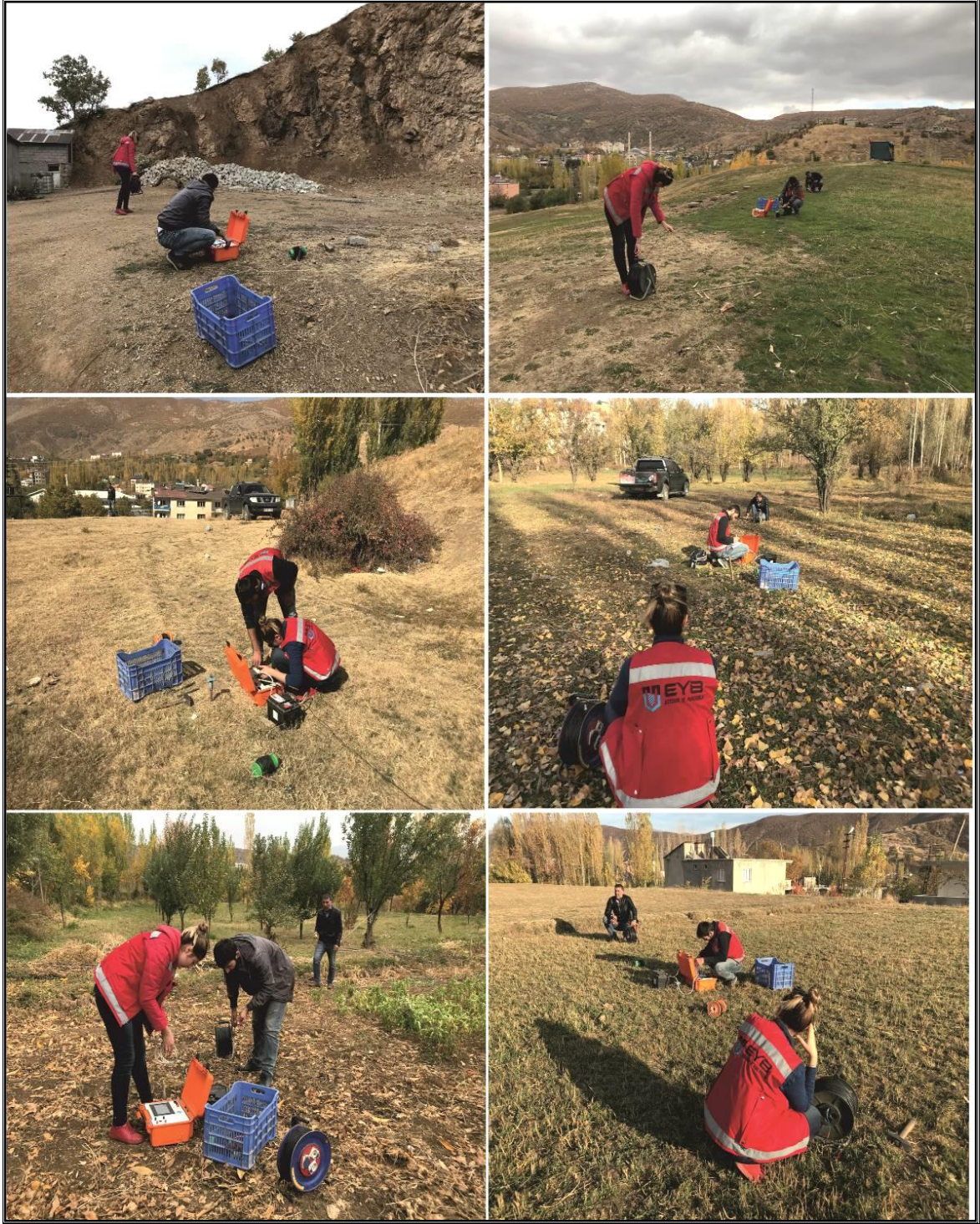
Şekil 3.15. Çalışma alanında yapılan düşey elektrik sondaj yönteminden görünümeler
