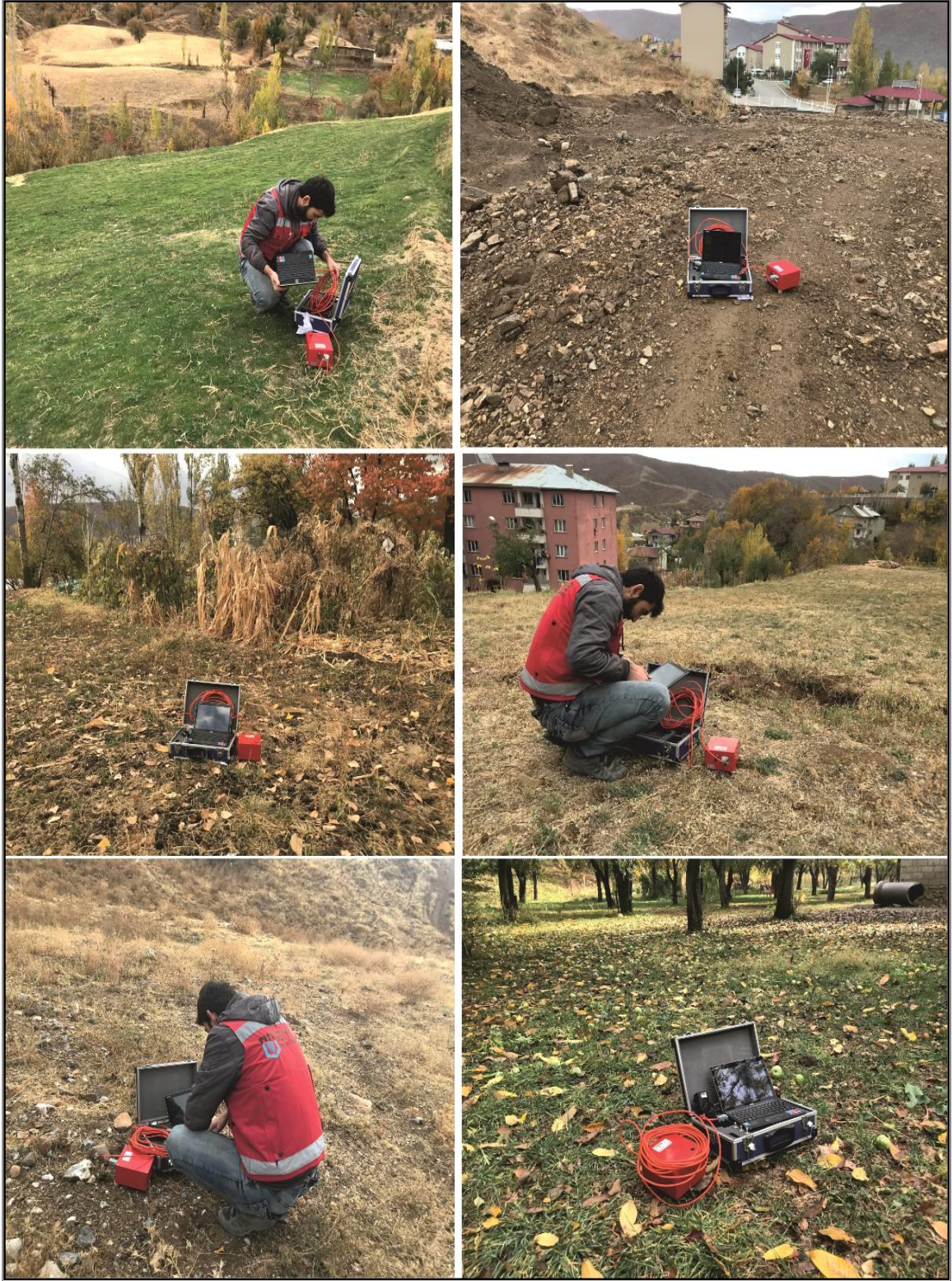
Şekil 3.16. Çalışma alanındaki Mikrotremor çalışmalarından görünümeler
