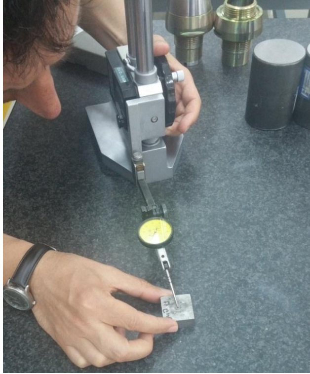
Şekil 3.3: Şahit plaka derinlik ölçümü.
