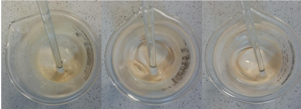
Şekil 2.9: HNS-IV/Kel-F karışımının çözücü uzaklaştırma öncesi görünümüleri.
