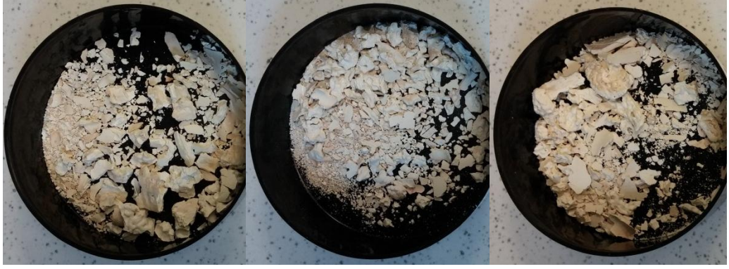
Şekil 2.11: HNS-IV/Kel-F karışımının kurutma sonrası görünümüleri.
