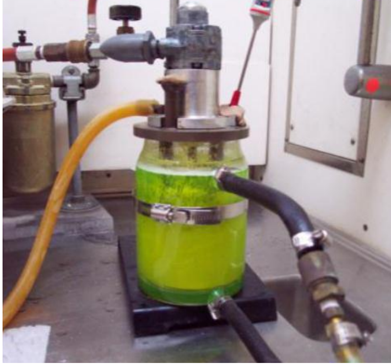
Şekil 1.9: Holston reaktörü: Patlayıcının su içerisinde dağılmış görüntüsü (LX-17-2-ATK) [14].
