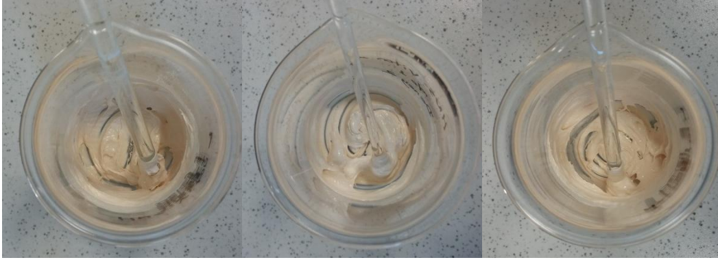
Şekil 2.8: HNS-IV/Viton-A karışımının çözücü uzaklaştırma öncesi görünümüleri.
