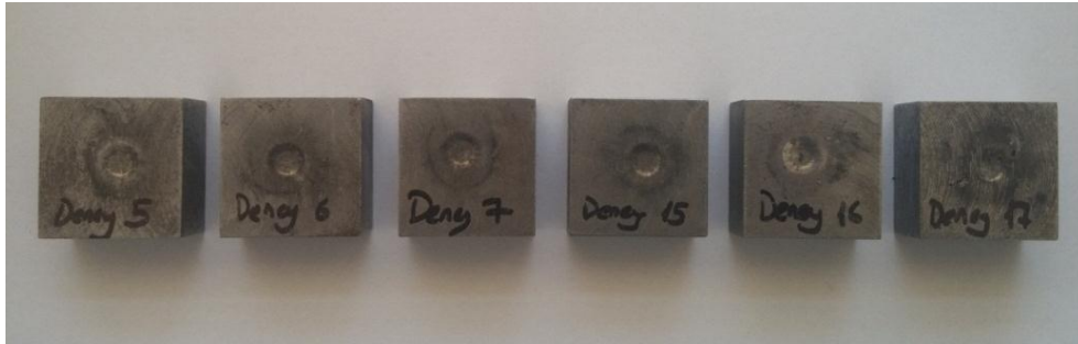
Şekil 3.2: Patlaması gerçekleşen peletlere ait şahit plakalar.
