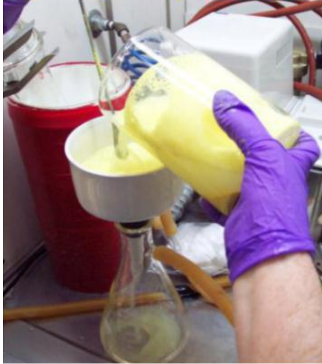
Şekil 1.11: Karışımın vakum ortamında buchner funnel ile filtreden geçirilmesi (LX-17-2-ATK) [14].
