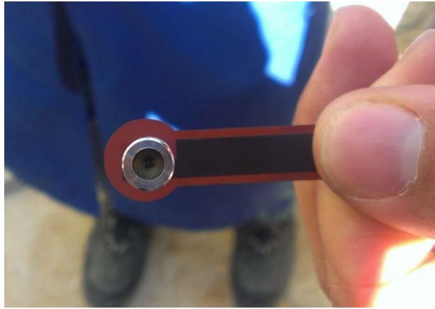
Şekil 2.12: Patlayıcı peletin yerleştirildiği patlayan folyolu başlatma elemanı.
