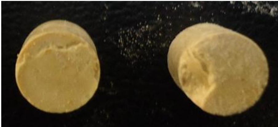
Şekil 3.41: Pelet olarak tedarik edilen HNS-IV patlayıcısı.
