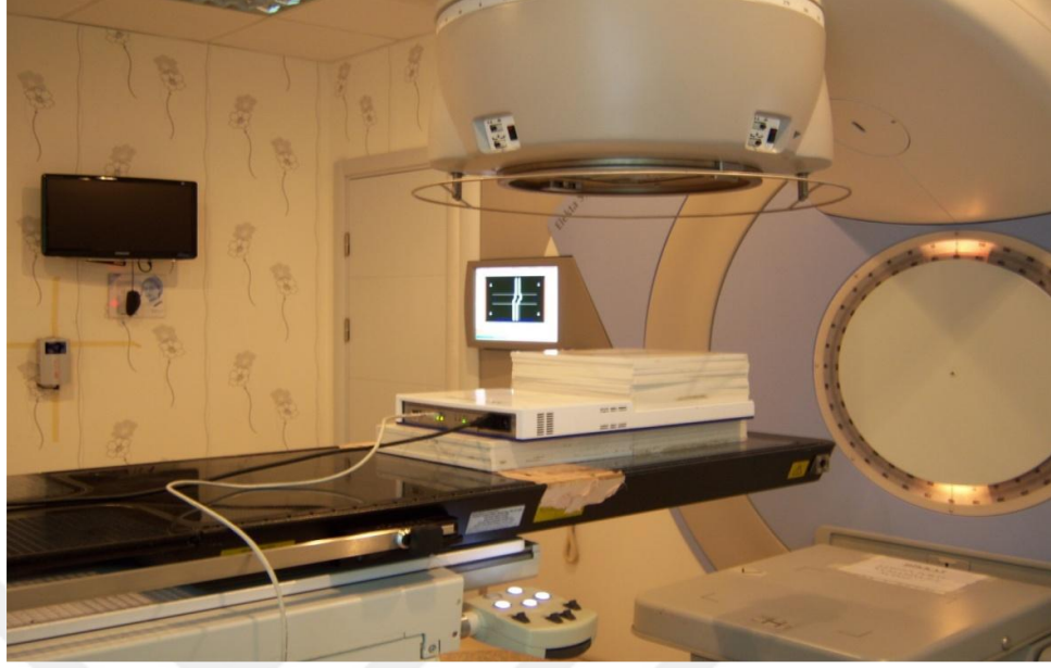
Şekil 3.15. İki boyutlu doz kontrol düzeneği (Akdeniz Üniversitesi Radyasyon Onkolojisi A.D.).
