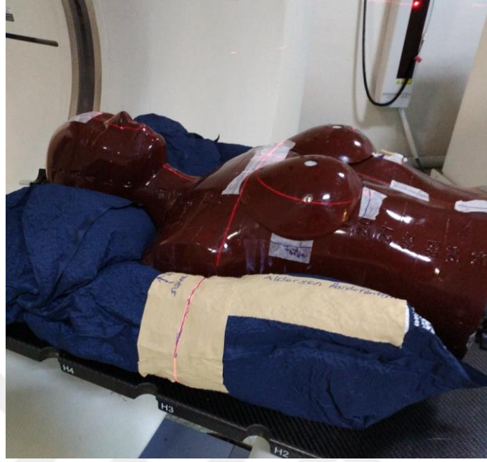
Şekil 3.12. Rando fantomun supin pozisyonda BT çekimi
