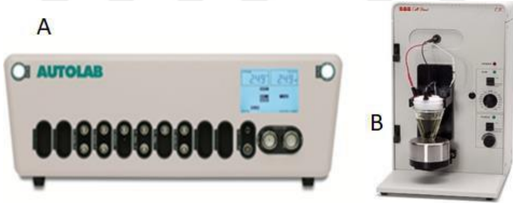
Şekil 3.1. Elektrokimyasal analiz cihazı (A) ve üç elektrotlu hücre ünitesi (B)
