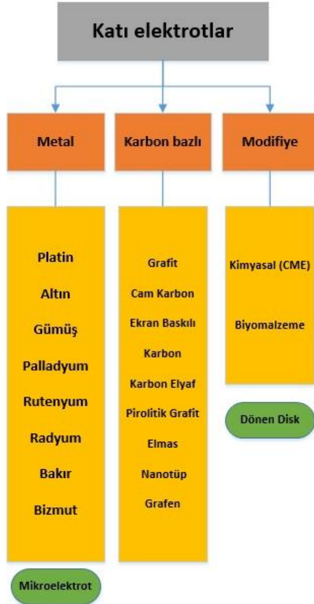
řekil 2.4. Halen kullanımda olan bazı katı elektrot örnekleri (Uslu ve Özkan, 2007a)
