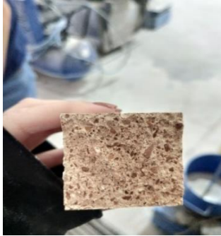
Şekil E.12. 50 gr uçucu kül içeren numune
