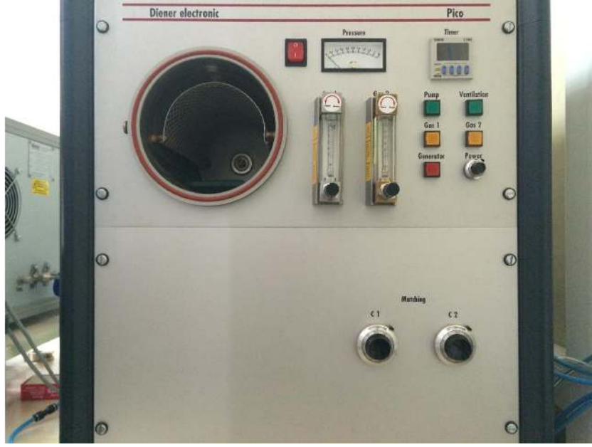
Şekil 3.5 Düşük basınç, yüksek frekans plazma sistemi
