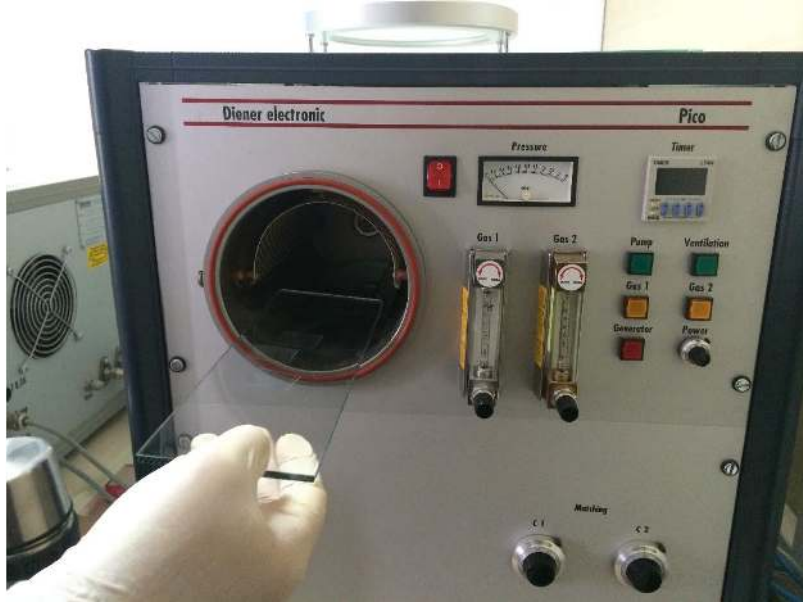
Şekil 3.7 Cam tutucaklar üzerine yerleştirilen slaytlar plazma odasına yerleştirilir.
