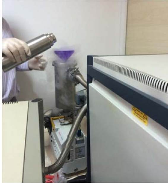
Şekil 3.8 Plazma oda basıncının düşmesi için ortama sıvı azot gazı eklenmesi
