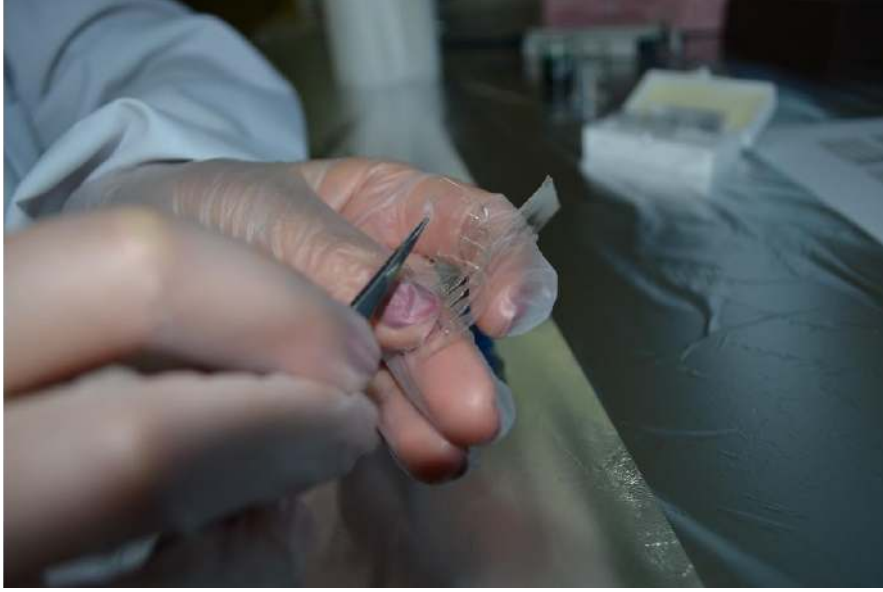
Şekil 3.3 DSA koruyucusunun çıkartılması
