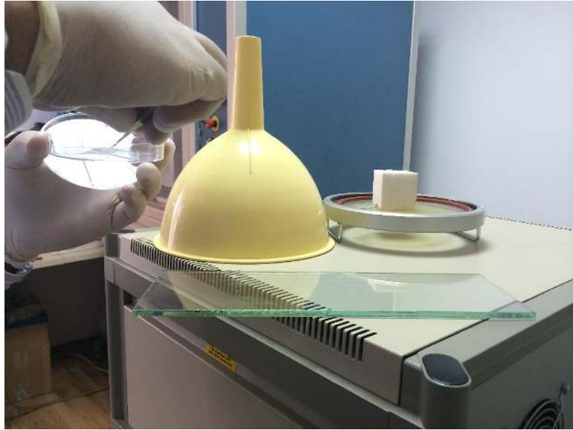
Şekil 3.6 Cam slaytların cam tutucaklar üzerine yerleştirilir.
