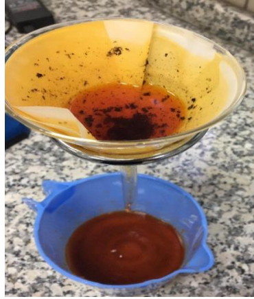
Şekil 3.9. MHÇHK ile metil oranj adsorpsiyonu
