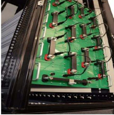
Şekil 2.15. UPS'lerde kullanılan süperkapasitör modülü (Ioxus Inc).
