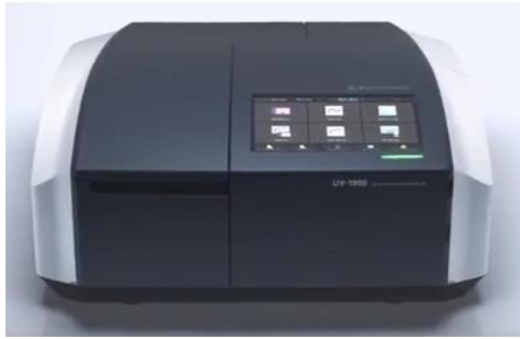
Şekil 3.4. UV-vis spektrofotometre (Shimadzu UV-1900i) cihazı
