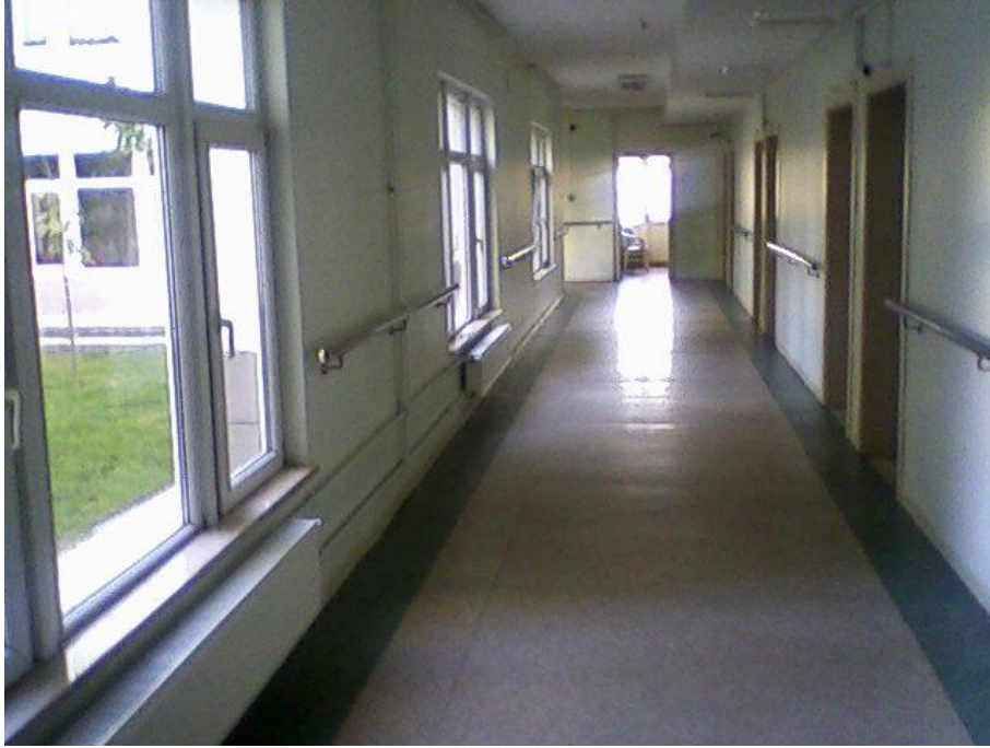
Resim 4.11. Huzurevi PVC zemin kaplamaları -Ankara Seyranbağları
