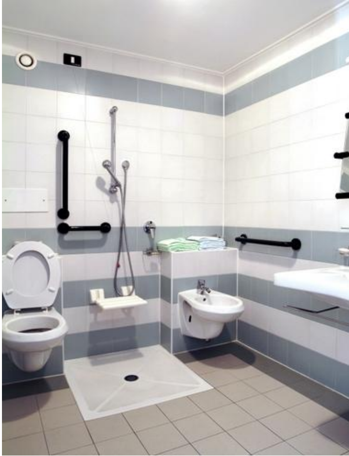
Resim 5.4. Tekerlekli sandalye kullanıcısı için banyo-tuvalet önerisi
