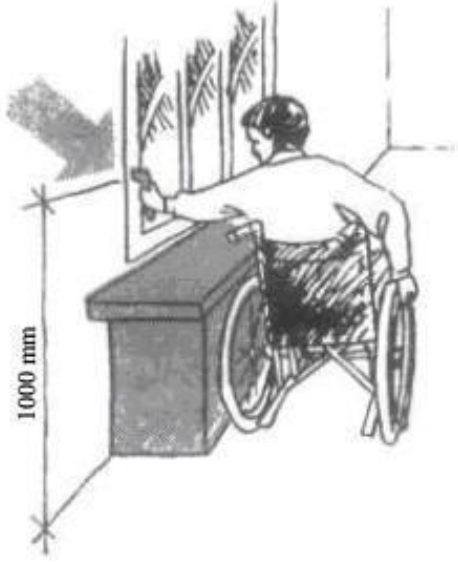
Şekil 2.19. Herhangi bir engel olduğunda pencere kol yüksekliği [36]
