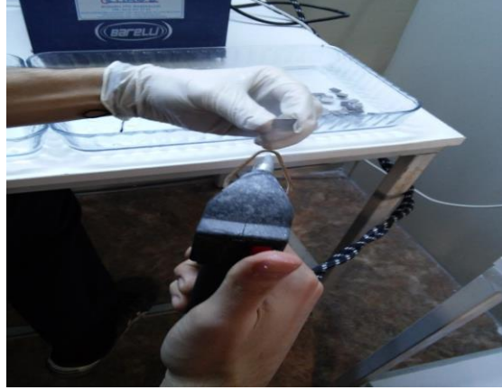
Resim 5.3 Buhar basınçlı tabanca ile Ti6Al4V numunelerin temizlenmesi.
