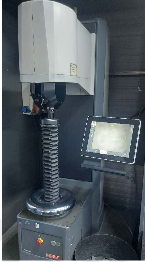
Şekil 0.5 EMCOTEST DuraScan 30 G5 model sertlik ölçüm cihazı
