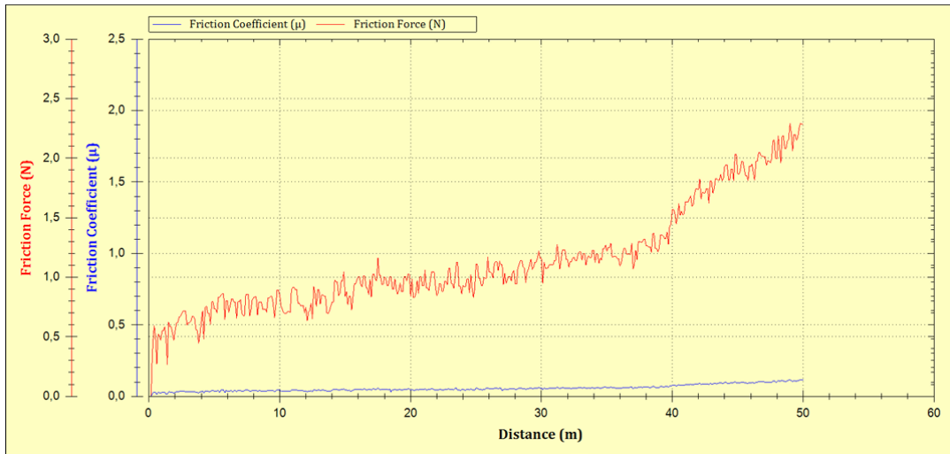
Şekil 4.14. WC–Co kaplamalı numuneye ait sürtünme kuvveti ve katsayısı profili
