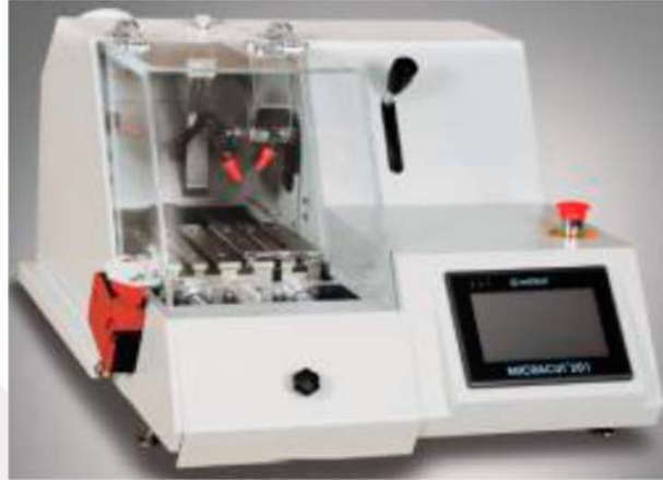
Şekil 3.8 WC-Co ve WC-Co(Cr) kaplamalı dökme demir numunelerin enine kesit incelemesi için dilimlere ayrılmasında kullanılan Metkon Micracut 201 model hassas kesici.
