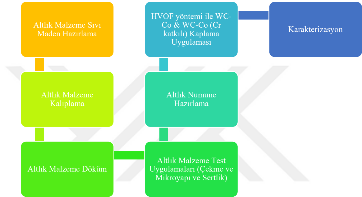
Şekil 3.1. Altık ve kaplama genel süreç tanımı
