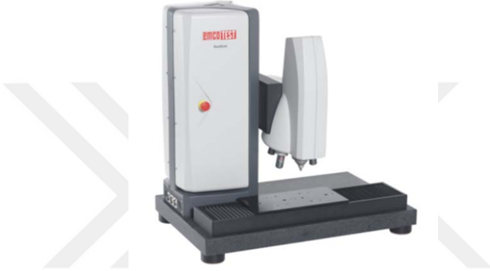
Şekil 3.10 Emco DuraScan-80 G5 model mikro sertlik cihazı.
