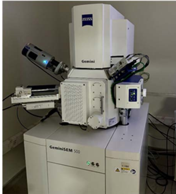
Şekil 3.9 Zeiss Gemini 500 model FESEM cihazı
