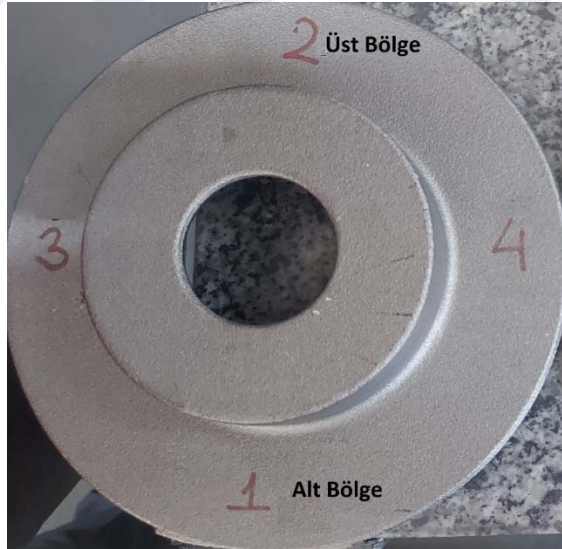
Şekil 3.6. Sertlik ve çekme testleri için parça üzerinde bölge seçimi (DISA dikey kalıplama yöntemiyle üretilen fren diski)
