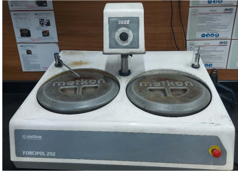
Şekil 3.4 Metkon Forcipol 202 model zımpara-parlatma cihazı
