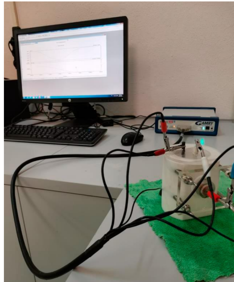
Şekil 3.14. Gamry Interface 1010B Potansiyostat-Galvanostat elektrokimyasal korozyon deney düzeneği
