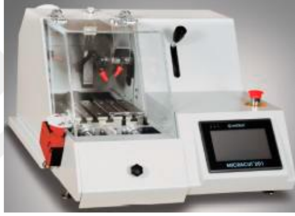
Şekil 3.10. Kaplamalı numunelerin enine kesit incelemesi için kesilmesinde kullanılan Metkon Micracut 201 model hassas kesici
