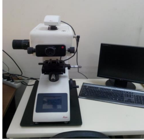
Şekil 5.1. Sertlik ölçümlerinin yapıldığı mikro sertlik cihazı.
