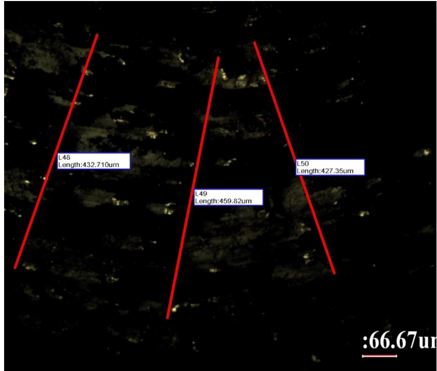
Şekil 6.23 5x büyütmede optik mikroskop ile alınan z8-3 no lu numuneye ait aşınma iz genişliği gösterimi.
