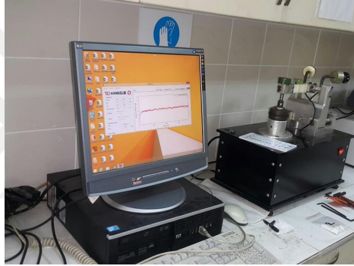
Şekil 5.2. ASTM G133 standardına uygun aşınma cihazı.
