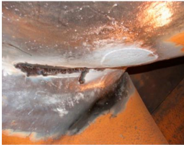
Şekil 3.4. Kılavuz kanadına ait bir eroziyon aşınma örneği [13].
