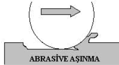
Şekil 3.2. Abrasif aşınma şematik gösterimi (Yıldız, 2006).
