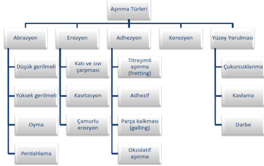
Şekil 3.1. Aşınma türleri ve sınıflandırılması (Stokes, 2003).
