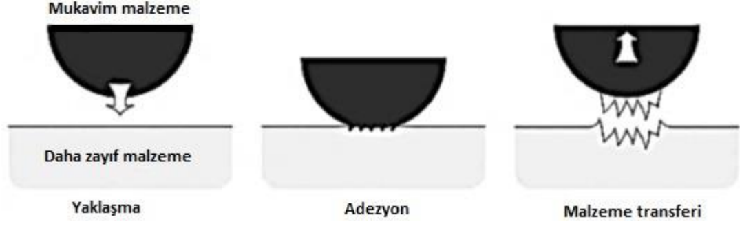
Şekil 3.5. Adhesif aşınma mekanizmasının şematik gösterimi (Biçer, 2015).
