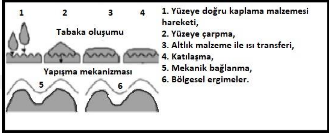
Şekil 2.7. Termal sprej tabakası oluşumu (Bunshah, 2001).
