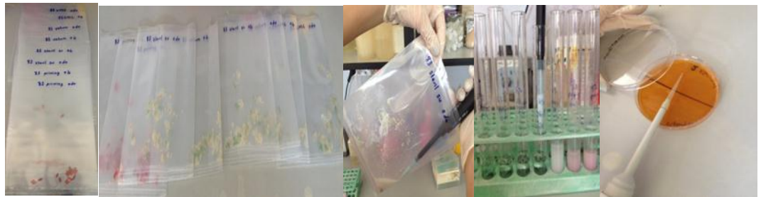
Şekil 3.5. Farklı tohum uygulamalarının EB'lerin populasyon yoğunluğuna etkilerinin testlenmesi (soldan sağa: tohumların tartılıp ezilmesi, seyreltme serilerinin hazırlanması ve rif200ppm içeren TSA besiyerine ekilmesi).
