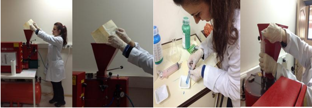
Şekil 3.3. Tohumlara bakteri süspansiyonlarının Cc-lab (Centricoater) yardımıyla film kaplama tekniğinin uygulanışı.
