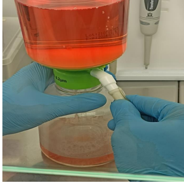
Resim 3.1. Hücre kültürü analizlerinde kullanılan besiyerlerinin hazırlanmasında kullanılan pes membran filtre düzeneği
