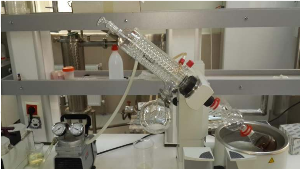
Şekil 3.1. Ekstredeki çözgen (metanol) rotavaporda uçurularak uzaklaştırılması.
