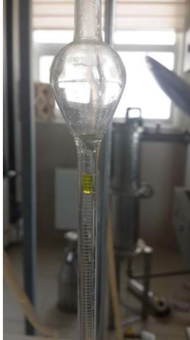
Şekil 3.2. Clavenger tipi aparat ile distile edilen uçucu yağın görüntüsü (TA 3017 nolu örnek).
