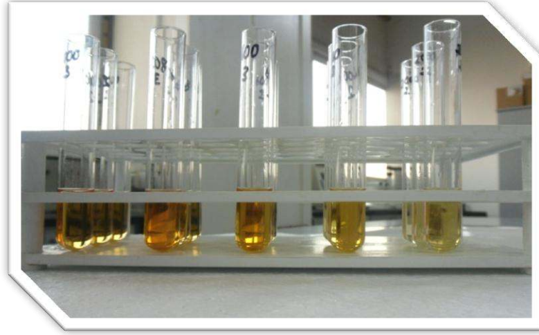
Şekil 5.6 Standart grafiği için kullanılan farklı konsantrasyondaki \text{NH}_4\text{Cl} çözeltileri
