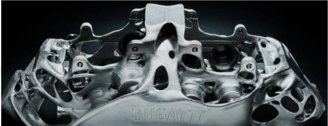
Şekil 1.8. Bugatti firmasının 3d baskı teknolojisiyle ürettiği fren kaliperi [8]
