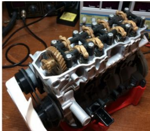
Şekil 1.7. Toyota'nın 3d baskı teknolojisiyle ürettiği 22RE Model 4 silindirli motor protoipi [8]
