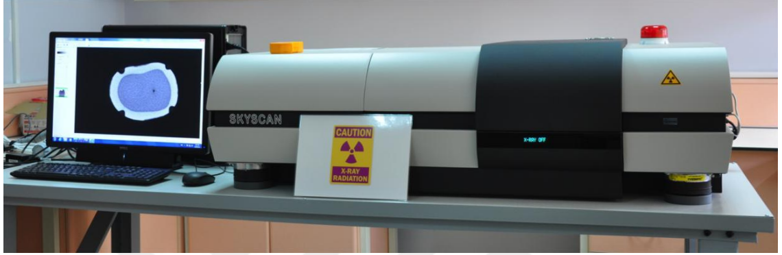
Şekil 3.5. Çalışmada taramalar için kullanılan Skyscan 1172 Mikro-BT sistemi
