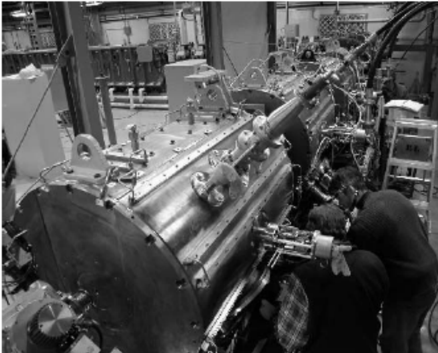
Resim 3.5. ISAC-I deney alanındaki DTL hızlandırıcısı
