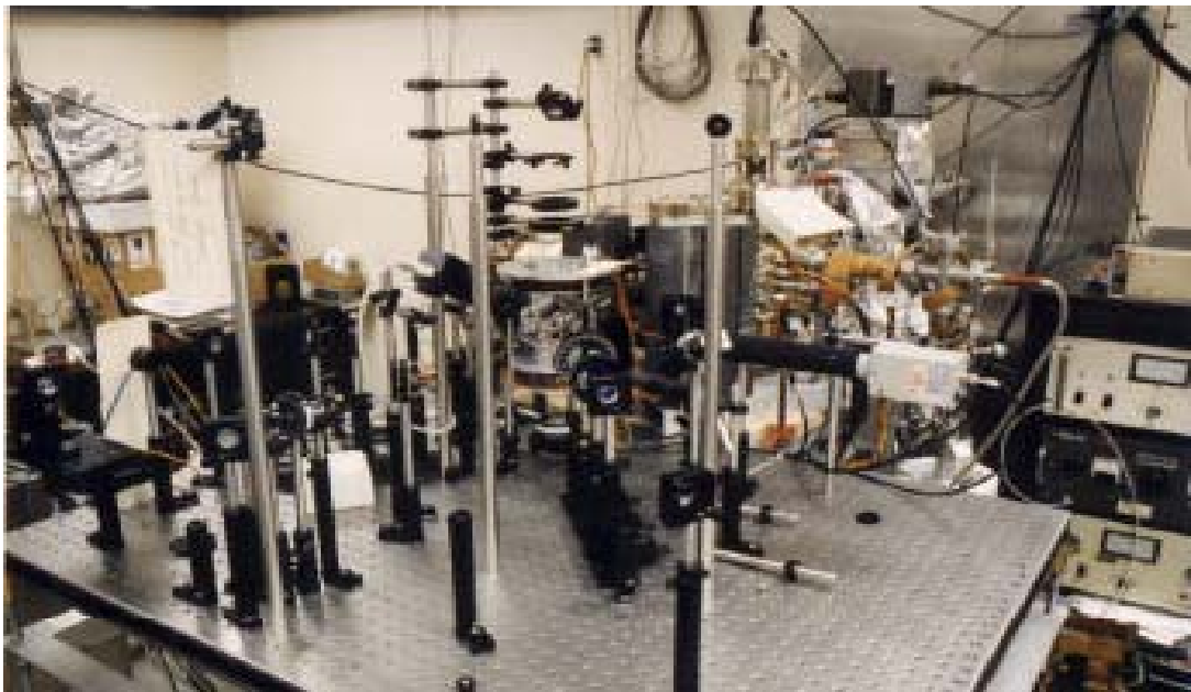
Resim 3.3. TRINAT sisteminde kullanılan Lazer masası
