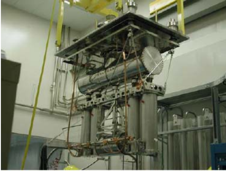
Resim 3.6. ISAC-II’de kullanılan süperiletken linakın bir bölümü
