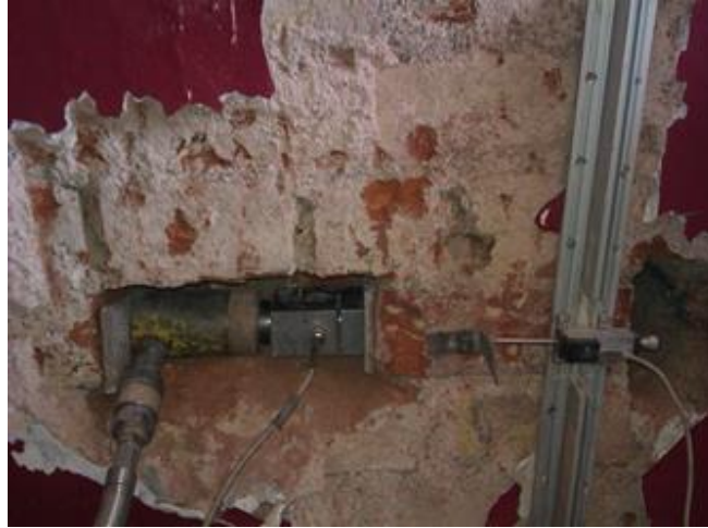
Şekil 3.19: Yerinde kayma deneyi.
