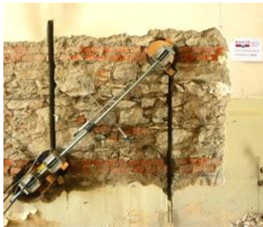
Şekil 2.11: Numune üzerindeki diyagonal basınç testi [14].
