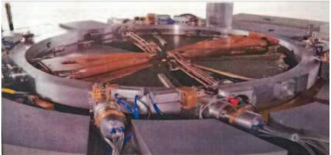
Şekil 3.8. Rf Dee'leri (180° karşılıklı duran bakır bölge)
