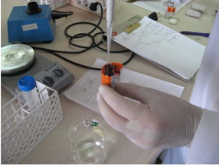
Resim 3.1: İbandronik asitin enjeksiyonluk çözeltisinin hazırlanması: İbandronik asit monosodyum monohidrat tuzunun distile suda çözelti haline getirilmesi
