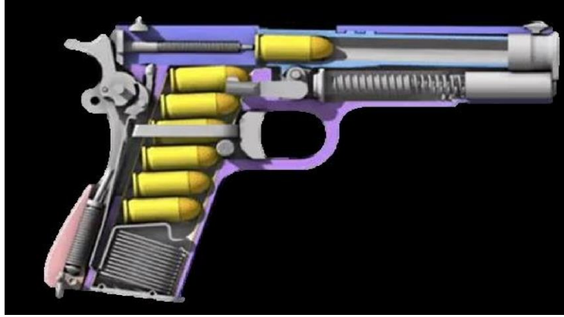
Şekil 5.1.Otomatik tabanca çalışma prensibi
