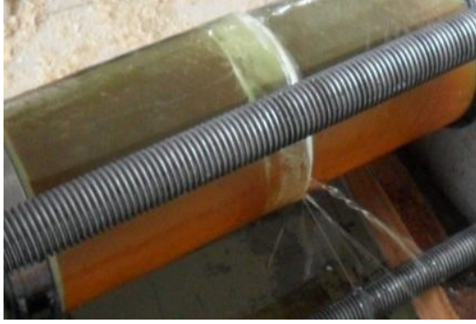
Şekil 4.57. DP 410 yapıştırıcı ile 20 mm bindirme uzunluğunda kademeli olarak yapıştırılan 55^{\circ}/-55^{\circ}/55^{\circ}/-55^{\circ} oryantasyon açılı tabakalı kompozit boruların hasar durumları
