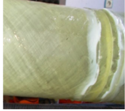
Şekil 4.23. DP 410 yapıştırıcı ile 20 mm yama kullanarak yapıştırılan 45^0/-45^0/45^0/-45^0 oryantasyon açılı tabakalı kompozit boruların hasar durumları
