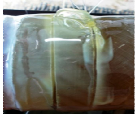
Şekil 4.27. DP 410 yapıştırıcı ile 40 mm yama kullanılarak yapıştırılan 45^0/-45^0/45^0/-45^0 oryantasyon açılı tabakalı kompozit boruların hasar durumları
