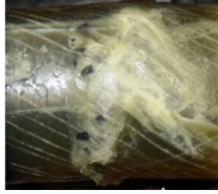
Şekil 4.32. DP 490 yapıştırıcı ile 30 mm yama kullanılarak yapıştırılan 55^0/-55^0/30^0 /-30^0 oryantasyon açılı tabakalı kompozit boruların hasar durumları
