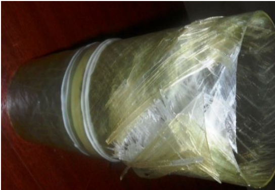
Şekil 4.31. DP 410 yapıştırıcı ile 30 mm yama kullanılarak yapıştırılan 55^0/-55^0/30^0 /-30^0 oryantasyon açılı tabakalı kompozit boruların hasar durumları
