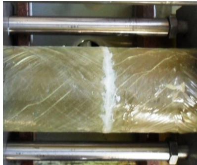
Şekil 4.19. DP 410 türü yapıştırıcı ile alın altına birleştirilmiş 55^0/-55^0/30^0/-30^0 oryantasyon açılı tabakalı kompozit boruların hasar durumları
