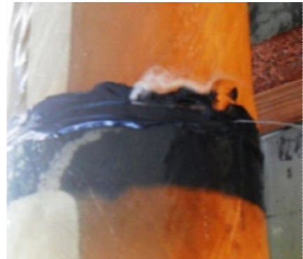
Şekil 4.52. DP 490 yapıştırıcı ile 20 mm bindirme uzunluğunda kademeli olarak yapıştırılan 55^0/-55^0/30^0/-30^0 oryantasyon açılı tabakalı kompozit boruların hasar durumları
