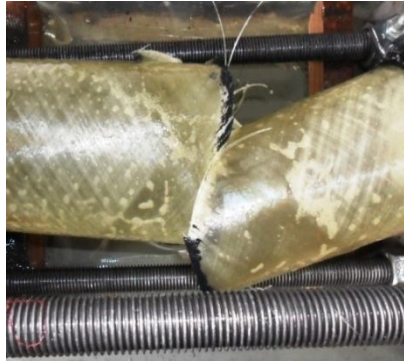
Şekil 4.22. DP 490 türü yapıştırıcı ile alın altına birleştirilmiş 55^0/-55^0/55^0/-55^0 oryantasyon açılı tabakalı kompozit boruların hasar durumları
