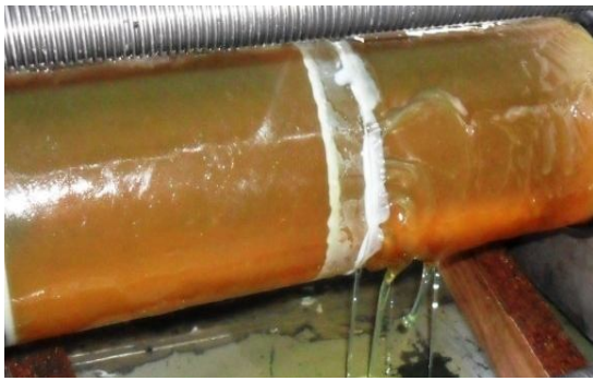
Şekil 4.55. DP 410 yapıştırıcı ile 15 mm bindirme uzunluğunda kademeli olarak yapıştırılan 55^0/-55^0/55^0/-55^0 oryantasyon açılı tabakalı kompozit boruların hasar durumları
