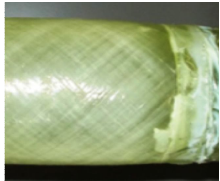
Şekil 4.43. DP 410 yapıştırıcı ile 15 mm bindirme uzunluğunda kademeli olarak yapıştırılan 45^{\circ}/-45^{\circ}/45^{\circ}/-45^{\circ} oryantasyon açılı tabakalı kompozit boruların hasar durumları
