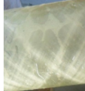
Şekil 4.16. 55^0/-55^0/55^0/-55^0 oryantasyon açılı tabakalı kompozit boruların hasar deneyleri
