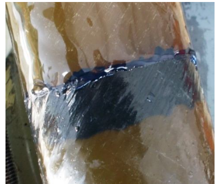
Şekil 4.46. DP 490 yapıştırıcı ile 20 mm bindirme uzunluğunda kademeli olarak yapıştırılan 45^0/-45^0/45^0/-45^0 oryantasyon açılı tabakalı kompozit boruların hasar durumları
