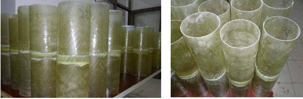
Şekil 3.9. Deneysel çalışmalar için hazırlanmış 4 tabakalı kompozit boruların yapıştırıcı malzemeleri kullanarak birleştirilmesi
