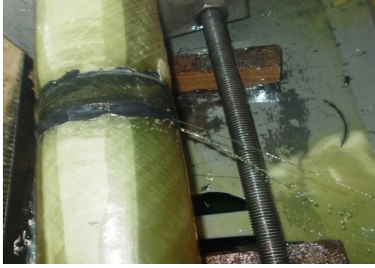
Şekil 4.26. DP 490 yapıştırıcı ile 30 mm yama kullanılarak yapıştırılan 45^0/-45^0/45^0/-45^0 oryantasyon açılı tabakalı kompozit boruların hasar durumları
