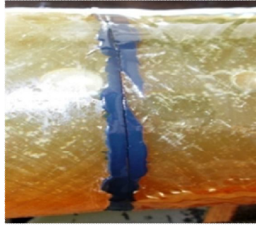
Şekil 4.18. DP 490 yapıştırıcı ile alın altına birleştirilmiş 45^0/-45^0/45^0/-45^0 oryantasyon açılı tabakalı kompozit boruların hasar durumları
