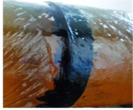
Şekil 4.54. DP 490 yapıştırıcı ile 10 mm bindirme uzunluğunda kademeli olarak yapıştırılan 55^0/-55^0/55^0/-55^0 oryantasyon açılı tabakalı kompozit boruların hasar durumları
