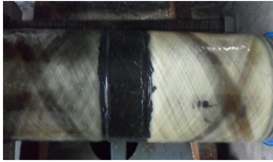
Şekil 4.40. DP 490 yapıştırıcı ile 40 mm yama kullanılarak yapıştırılan 55^{\circ}/-55^{\circ}/55^{\circ}/-55^{\circ} oryantasyon açılı tabakalı kompozit boruların hasar durumları
