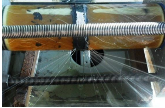
Şekil 4.30. DP 490 yapıştırıcı ile 20 mm yama kullanılarak yapıştırılan 55^0/-55^0/30^0 /-30^0 oryantasyon açılı tabakalı kompozit boruların hasar durumları
