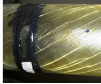
Şekil 4.30. DP 490 yapıştırıcı ile 20 mm yama kullanılarak yapıştırılan 55^0/-55^0/30^0 /-30^0 oryantasyon açılı tabakalı kompozit boruların hasar durumları
