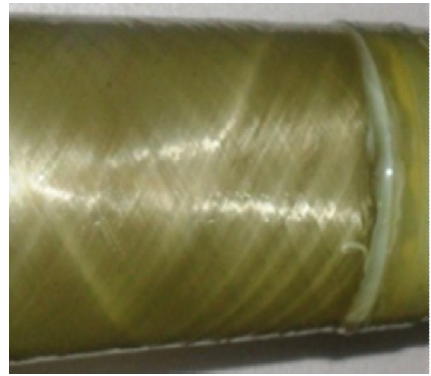
Şekil 4.37. DP 410 yapıştırıcı ile 30 mm yama kullanılarak yapıştırılan 55^0/-55^0/55^0/-55^0 oryantasyon açılı tabakalı kompozit boruların hasar durumları
