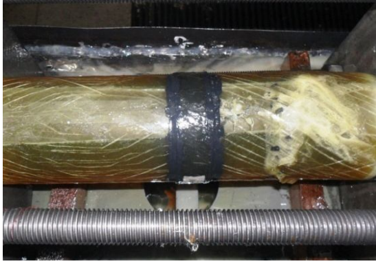
Şekil 4.32. DP 490 yapıştırıcı ile 30 mm yama kullanılarak yapıştırılan 55^0/-55^0/30^0 /-30^0 oryantasyon açılı tabakalı kompozit boruların hasar durumları
