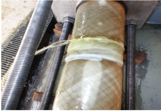
Şekil 4.27. DP 410 yapıştırıcı ile 40 mm yama kullanılarak yapıştırılan 45^0/-45^0/45^0/-45^0 oryantasyon açılı tabakalı kompozit boruların hasar durumları
