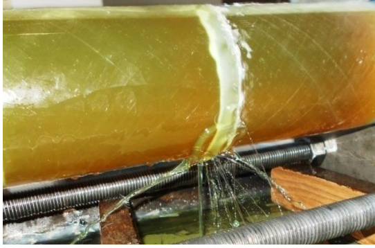
Şekil 4.41. DP 410 yapıştırıcı ile 10 mm bindirme uzunluğunda kademeli olarak yapıştırılan 45^{\circ}/-45^{\circ}/45^{\circ}/-45^{\circ} oryantasyon açılı tabakalı kompozit boruların hasar durumları
