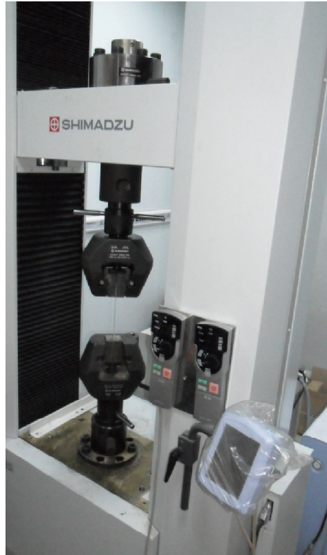
Şekil 3.20. Çeki-bası testlerinin yapıldığı Shimadzu marka test cihazı
