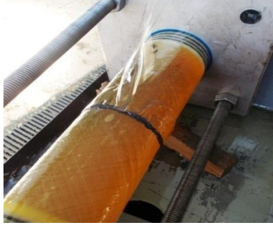
Şekil 4.18. DP 490 yapıştırıcı ile alın altına birleştirilmiş 45^0/-45^0/45^0/-45^0 oryantasyon açılı tabakalı kompozit boruların hasar durumları
