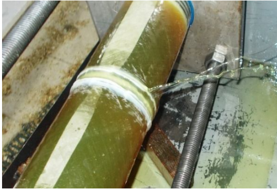
Şekil 4.25. DP 410 yapıştırıcı ile 30 mm yama kullanarak yapıştırılan 45^0/-45^0/45^0/-45^0 oryantasyon açılı tabakalı kompozit boruların hasar durumları
