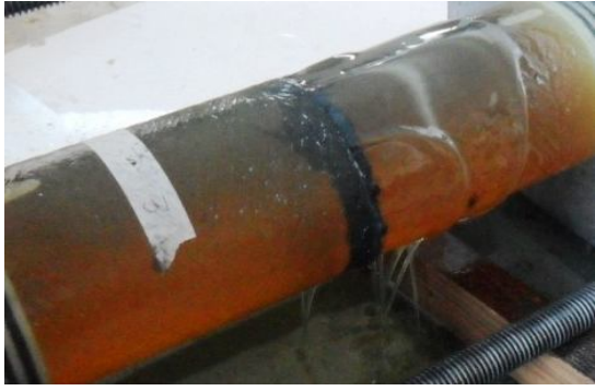
Şekil 4.54. DP 490 yapıştırıcı ile 10 mm bindirme uzunluğunda kademeli olarak yapıştırılan 55^0/-55^0/55^0/-55^0 oryantasyon açılı tabakalı kompozit boruların hasar durumları
