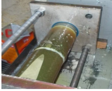
Şekil 4.17. DP 410 yapıştırıcı ile alın altına birleştirilmiş 45^0/-45^0/45^0/-45^0 oryantasyon açılı tabakalı kompozit boruların hasar durumları
