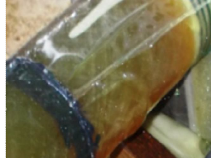
Şekil 4.42. DP 490 yapıştırıcı ile 10 mm bindirme uzunluğunda kademeli olarak yapıştırılan 45^{\circ}/-45^{\circ}/45^{\circ}/-45^{\circ} oryantasyon açılı tabakalı kompozit boruların hasar durumları
