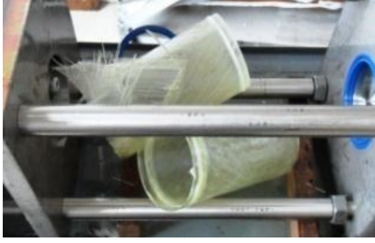
Şekil 4.29. DP 410 yapıştırıcı ile 20 mm yama kullanılarak yapıştırılan 55^0/-55^0/30^0 /-30^0 oryantasyon açılı tabakalı kompozit boruların hasar durumları
