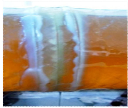
Şekil 4.25. DP 410 yapıştırıcı ile 30 mm yama kullanarak yapıştırılan 45^0/-45^0/45^0/-45^0 oryantasyon açılı tabakalı kompozit boruların hasar durumları
