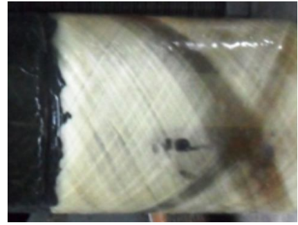
Şekil 4.40. DP 490 yapıştırıcı ile 40 mm yama kullanılarak yapıştırılan 55^{\circ}/-55^{\circ}/55^{\circ}/-55^{\circ} oryantasyon açılı tabakalı kompozit boruların hasar durumları
