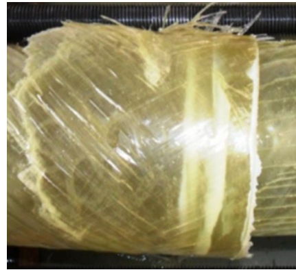
Şekil 4.49. DP 410 yapıştırıcı ile 15 mm bindirme uzunluğunda kademeli olarak yapıştırılan 55^0/-55^0/30^0/-30^0 oryantasyon açılı tabakalı kompozit boruların hasar durumları
