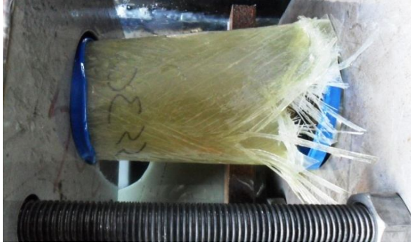
Şekil 4.15. 55^0/-55^0/30^0/-30^0 oryantasyon açılı tabakalı kompozit boruların hasar deneyleri
