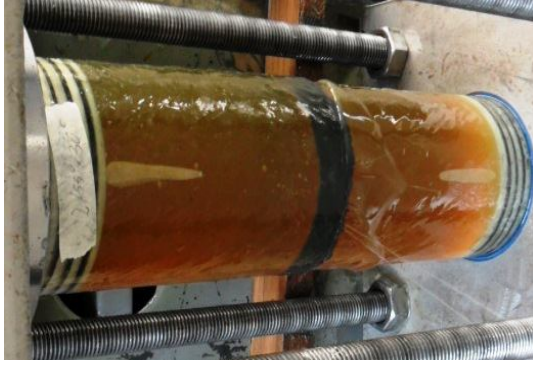
Şekil 4.50. DP 490 yapıştırıcı ile 15 mm bindirme uzunluğunda kademeli olarak yapıştırılan 55^0/-55^0/30^0/-30^0 oryantasyon açılı tabakalı kompozit boruların hasar durumları
