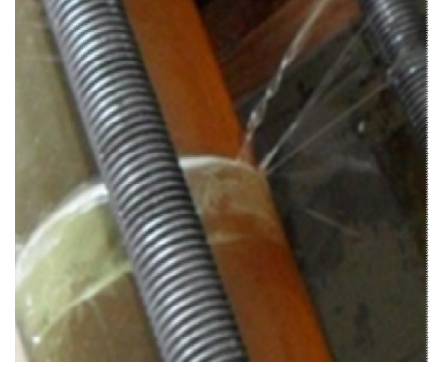
Şekil 4.57. DP 410 yapıştırıcı ile 20 mm bindirme uzunluğunda kademeli olarak yapıştırılan 55^{\circ}/-55^{\circ}/55^{\circ}/-55^{\circ} oryantasyon açılı tabakalı kompozit boruların hasar durumları
