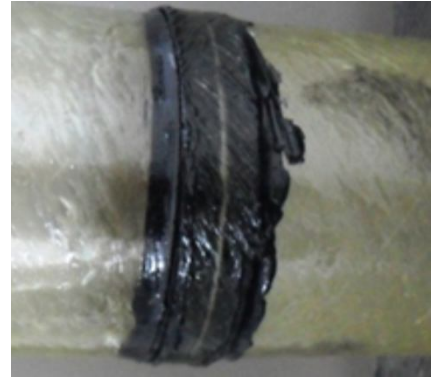
Şekil 4.36. DP 490 yapıştırıcı ile 20 mm yama kullanılarak yapıştırılan 55^0/-55^0/55^0/-55^0 oryantasyon açılı tabakalı kompozit boruların hasar durumları
