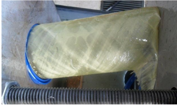
Şekil 4.16. 55^0/-55^0/55^0/-55^0 oryantasyon açılı tabakalı kompozit boruların hasar deneyleri
