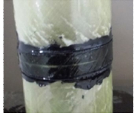
Şekil 4.24. DP 490 yapıştırıcı ile 20 mm yama kullanarak yapıştırılan 45^0/-45^0/45^0/-45^0 oryantasyon açılı tabakalı kompozit boruların hasar durumları
