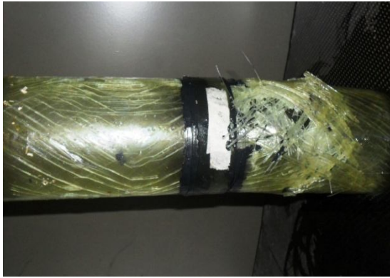
Şekil 4.34. DP 490 yapıştırıcı ile 40 mm yama kullanılarak yapıştırılan 55^0/-55^0/30^0 /-30^0 oryantasyon açılı tabakalı kompozit boruların hasar durumları
