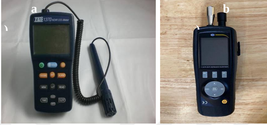
Şekil 3.1. Çalışmamızda Kullanılan Ölçüm Araçlarından Görüntüler a) TES 1370 CO 2 Ölçer b) PCE – PCO 1 Partikül Ölçer
