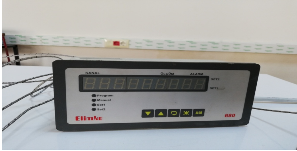
Şekil 5.4: Deney setinde kullanılan dijital sıcaklık göstergesi
