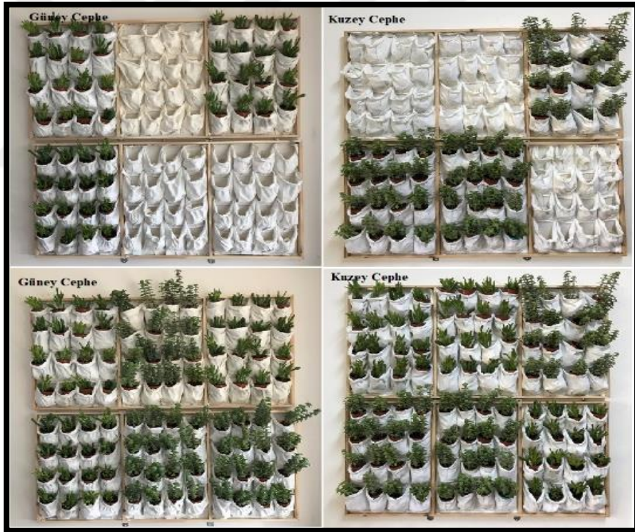
Şekil 3.15. Kuzey ve güney cephelerde dikey bahçe yerleşimi
