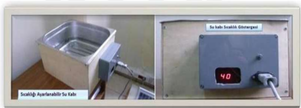
Şekil 4.2. Sıcak su elde etmede kullanılan ısıtıcı ve gösterge
