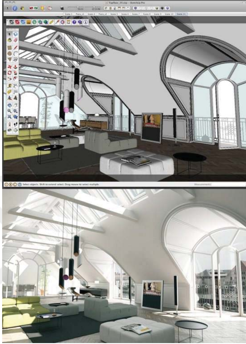
Görsel 3.23. SketchUp yazılımı kullanılarak hazırlanmış bir modelleme ve texturing işlemi (üstte) ve rendering işlemi ardından oluşmuş son ürün (altta)
