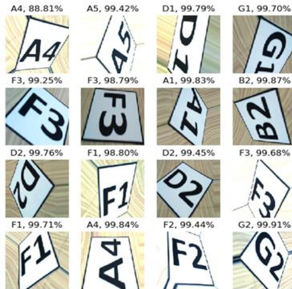
Şekil 5.3. Eğitilen CNN modeli için test seti sınıflandırma sonucu.
