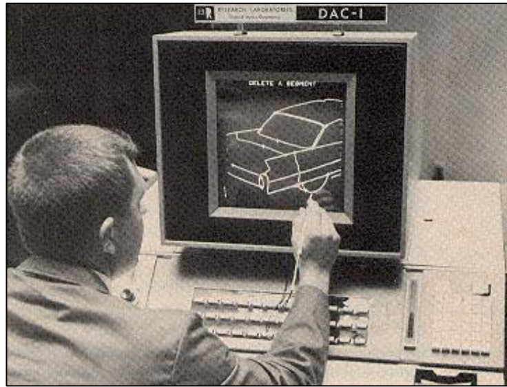
Şekil 2. General Motors için IBM tarafından geliştirilen ilk ticari CAD sistemi DAC-1
