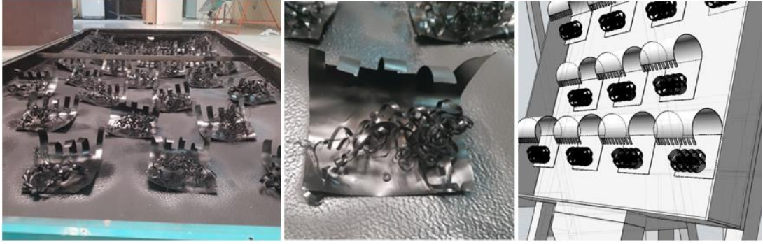
Şekil 5.8. Metal Talaşlı Havalı Güneş Kollektörü Montajı.
