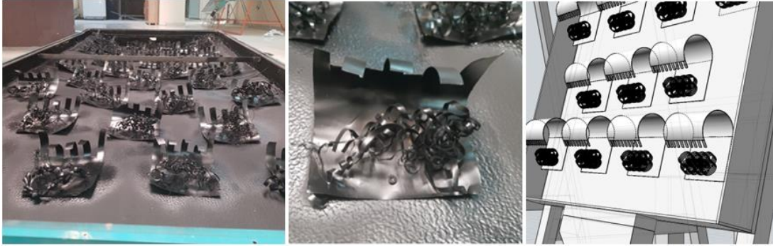
Şekil 5.8. Metal Talaşlı Havalı Güneş Kollektörü Montajı.
