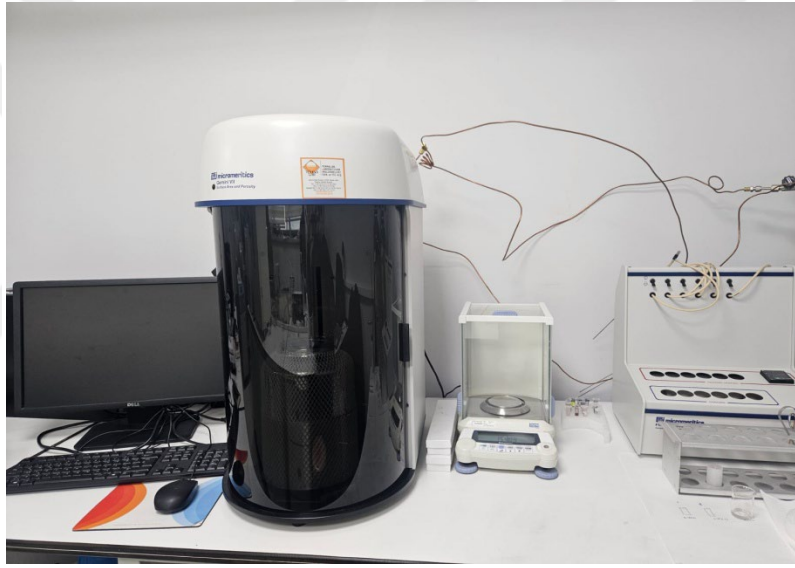
Şekil 3.7. Micromeritics Gemini VII 2390 model bilgisayar donanımlı BET cihazı.
