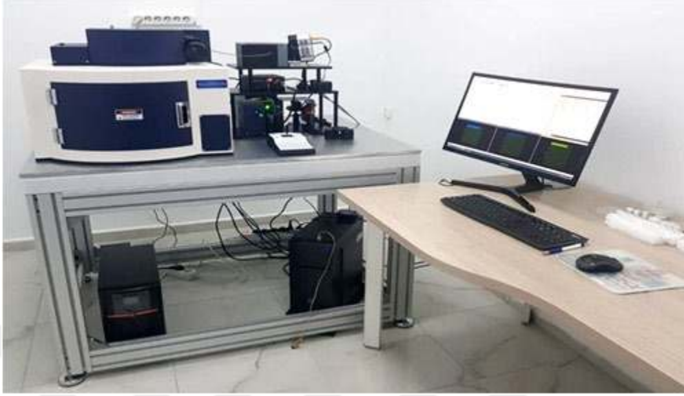
Şekil 3.5. 532 nm’lik UniDRON marka Raman spektroskopisi cihazı.
