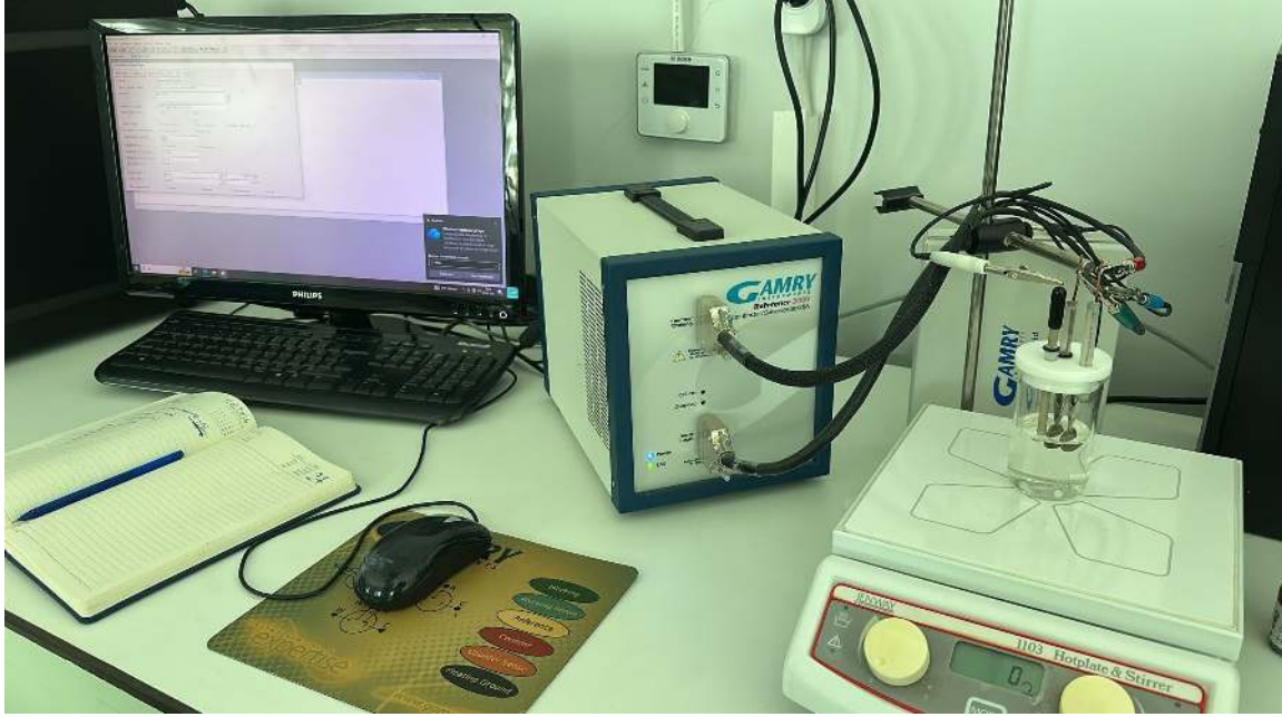
Şekil 3.9. Gamry Reference 3000 Gamry Reference 3000 potansiyastat/ galvanastant ZRA cihazı.
