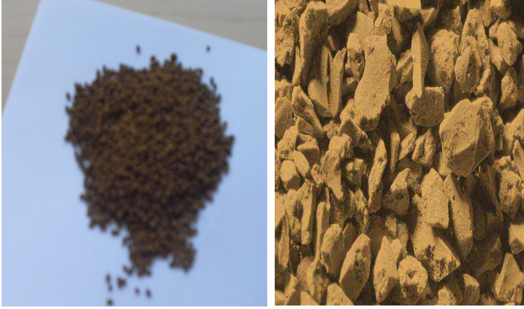
Şekil 3.4. Bayoxide® E33 ferrik oksit medyası
