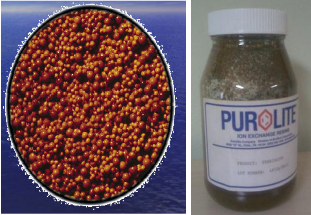
Şekil 3.3. Purolite Ferrix A33E arsenik giderim reçinesi
