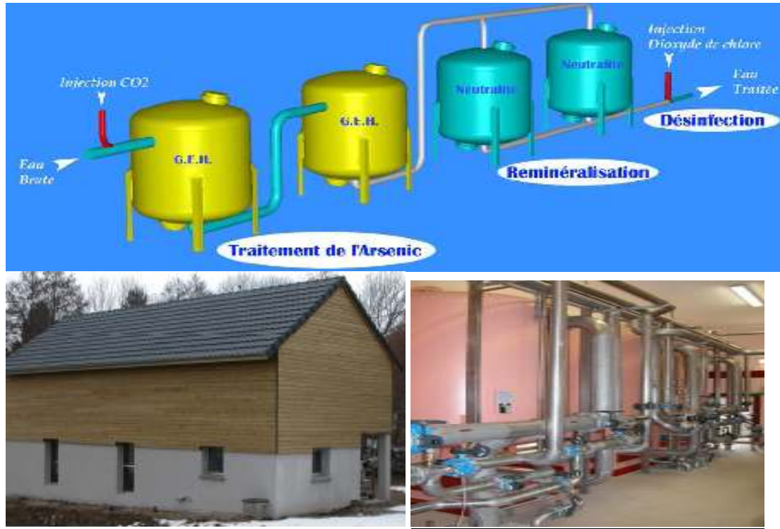
Şekil 2.2. Arsenik arıtma tesisinin farklı açılardan görüntüsü
