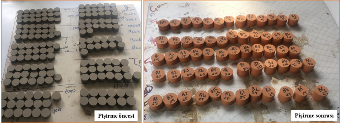
Şekil 4.7: Tuğla numunelerinin pişirme öncesi ve sonrası dijital fotoğraf görüntüleri
