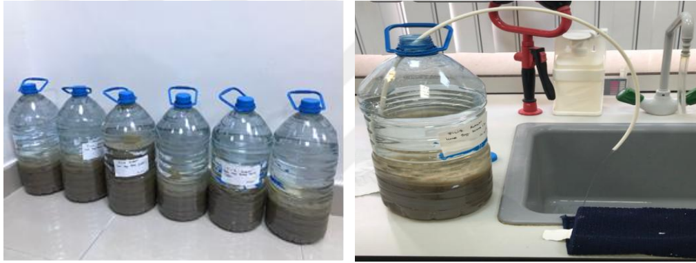
Şekil 3.8. Çamurun çökeltilmesi ve üst suyunun tahliyesi.
